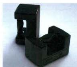
Рисунок 9 – Общий вид гирь в форме параллелепипеда с рукоятью
