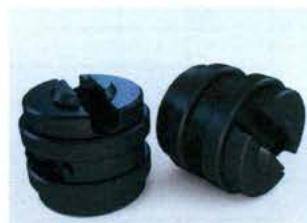
Рисунок 10 – Общий вид гирь в форме цилиндра с осью (слева) и с проушинами и посадочными местами для штабелирования (справа)
