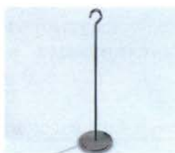
Рисунок 7 – Общий вид гирь в форме диска с крюком
