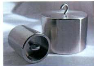
Рисунок 6 – Общий вид гирь в форме цилиндра с рукоятью (слева) и с крюком (справа)
