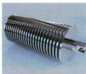
Рисунок 11 – Общий вид гирь наборных (составных)
