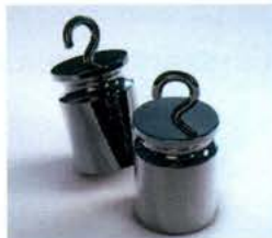
Рисунок 6 – Общий вид гирь в форме цилиндра с рукоятью (слева) и с крюком (справа)
