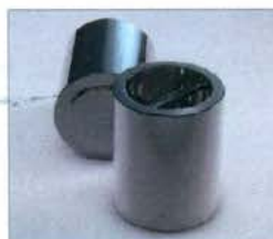
Рисунок 6 – Общий вид гирь в форме цилиндра с рукоятью (слева) и с крюком (справа)
