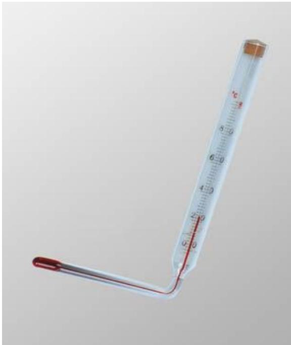
Принцип действия термометров основан на тепловом изменении объема термометрической жидкости, в зависимости от температуры измеряемой среды.
