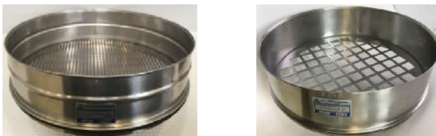
б) сита с просеивающей поверхностью из перфорированной металлической пластины
